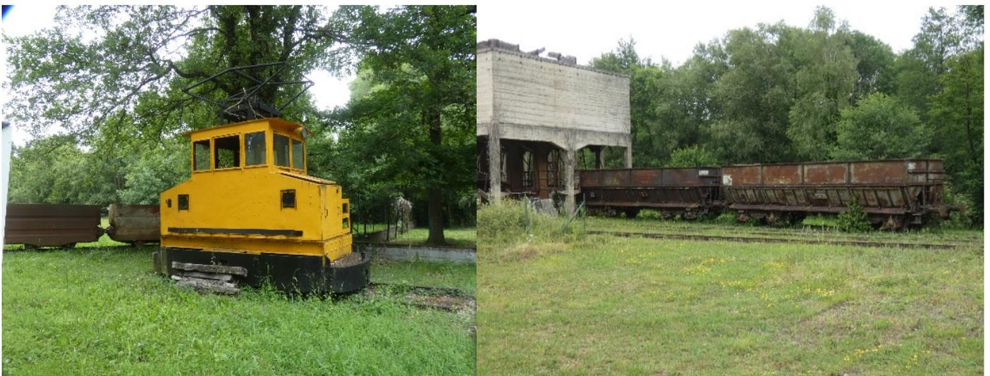
Le locotracteur électrique et les wagons SNCF à voie normale sous la trémie de chargement
